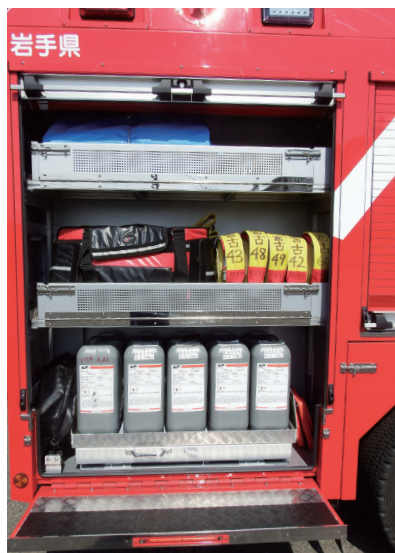
右側後方側面に泡消火薬剤を積載
